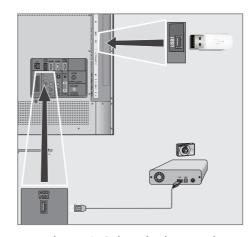
Buchse »USB2 (HDD)« des Fernsehgerätes und entsprechende Buchse des Datengerätes (externe Festplatte, Digital-Camera, Kartenlesegerät oder MP3-Player) mit einem USB-Kabel verbinden;
